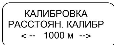
Измеряемое расстояние для автоматической калибровки (режим автоматического подсчета импульсов и расчета коэффициента ТС) задается в диапазоне от 20 до 1000 м.
